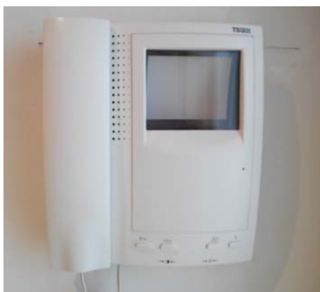
Imágenes 21 y 22. Videoportero con cámara que permite la visualización desde el interior pero no desde el exterior. / Elaboración propia.
