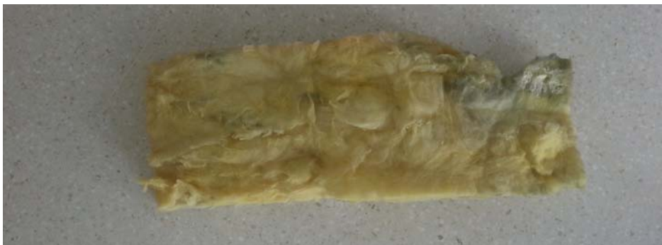
Imagen 12. Material poroso. Aislante. / Elaboración propia.
