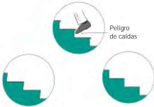
Escalones adecuados sin bocel e inadecuados con bocel
