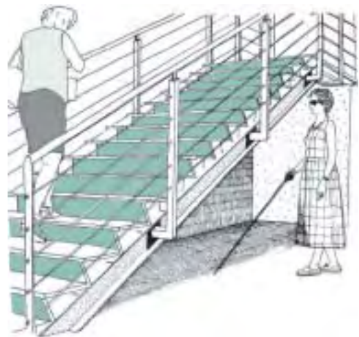
Ejemplo de mala práctica en accesibilidad, una persona con discapacidad visual podría golpearse al caminar bajo la escalera por la falta de un elemento de protección
