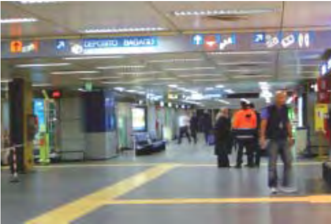
Aeropuerto de Linate, Milán. Señalización de dependencias en color contrastado. En el suelo franjas guía de encaminamiento
