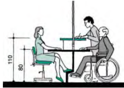
Mostrador a doble altura y con espacio para la aproximación de una persona en silla de ruedas
